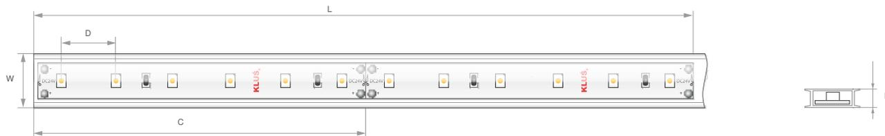
Dimensions: Breite [W]: 16.7 mm | Maximale Stromkabellänge [L]: 7.3 m | Schnittmöglichkeit je [C]: 100 mm | Abstand zwischen LEDs [D]: 16.7 mm | Höhe [H]: 4.6 mm
