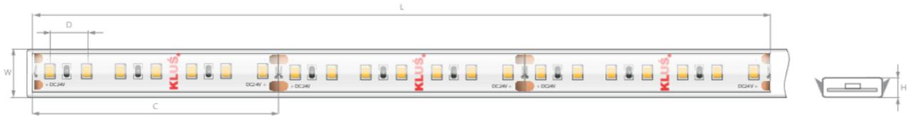
Dimensions: Breite [W]: 10 mm | Maximale Stromkabellänge [L]: 10 m | Schnittmöglichkeit je [C]: 50 mm | Abstand zwischen LEDs [D]: 6.25 mm | Höhe [H]: 4 mm
