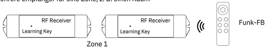
2) Zwei und mehr Funkempfänger für zwei und mehr separate Zonen, z. B. Räume
