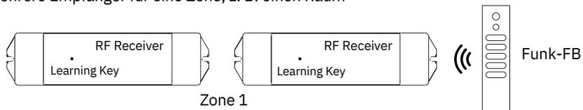
2) Zwei und mehr Funkempfänger für zwei und mehr separate Zonen, z. B. Räume
