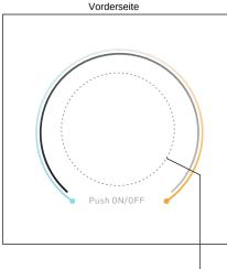
Durch Drehen des Drehknopfs im Uhrzeigersinn: Erhöhen Sie die Helligkeit Ändern Sie den Weißton auf einen wärmeren
