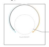
**Schritt 3:** Drehen oder drücken Sie den Drehknopf. Die LED blinkt kurz auf, d. h., das Gerät wurde erfolgreich gekoppelt.
